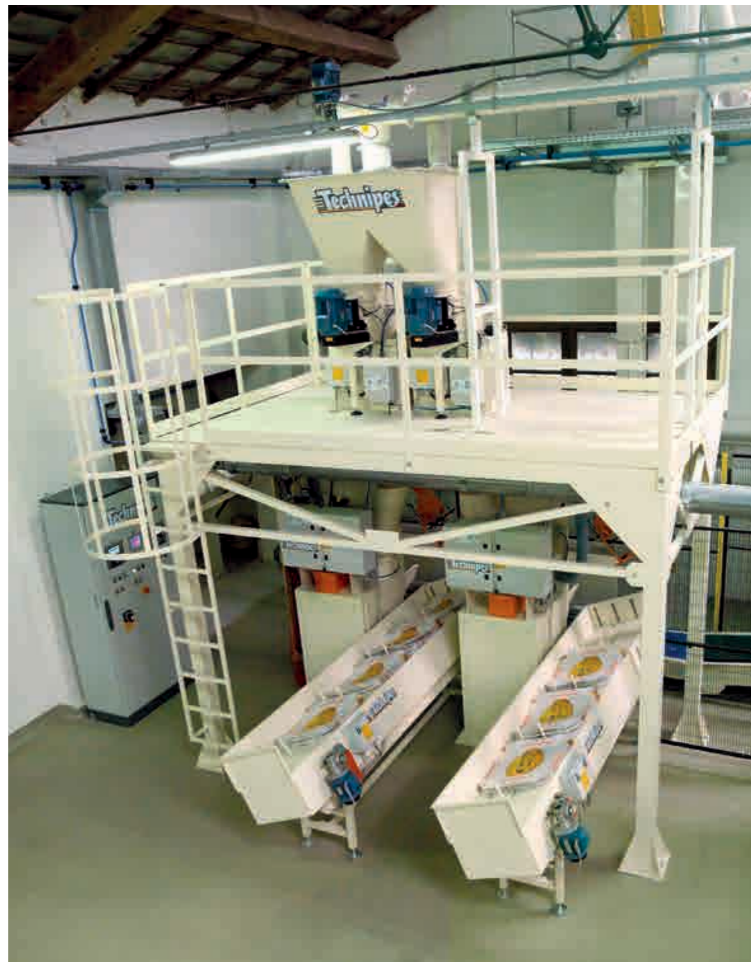
Stazione d'insacco a due bocche installato presso Mulino Giambastiani (Italia) Dual-spout bagging system installed at Mulino Giambastiani (Italy) Ensacheuse à deux bords d'ensachage installée au Moulin Giambastiani (Italie) Estación de ensacado de dos bocas instalada en Mulino Giambastiani (Italia)
